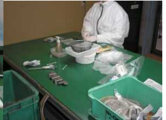
【電気製造・加工作業】両替機の中部品加工 ブルステージの研磨を指定された液を使用してウエス(布)で汚れを拭き取っていく作業
