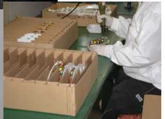
【電気製造・加工作業】蛍光灯の基盤製造工程 基盤を装飾板に電気ドライバーを使用しながらビスをはめ込み固定させていく作業
